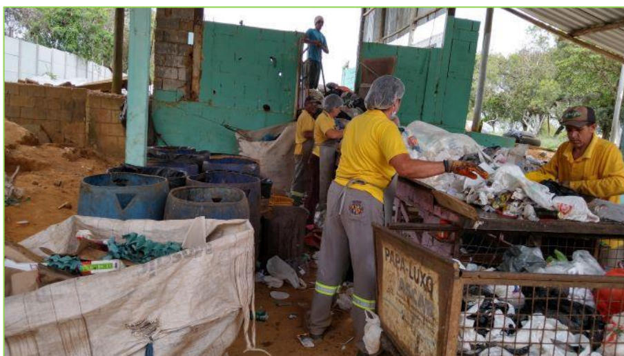
Figura 242: Trabalhadores da UTC de Prados, fazendo a separação dos materiais recicláveis na esteira.
