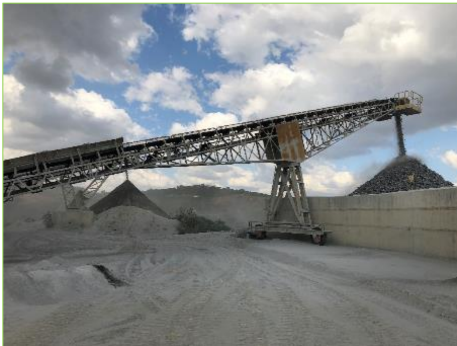
Figura 33: Transportadora de Correias Móvel TC02 à frente formando uma pilha de calcário com granulometria \geq à 6" e ao fundo Transportadora de Correias - TC05 formando uma pilha de moinha.
