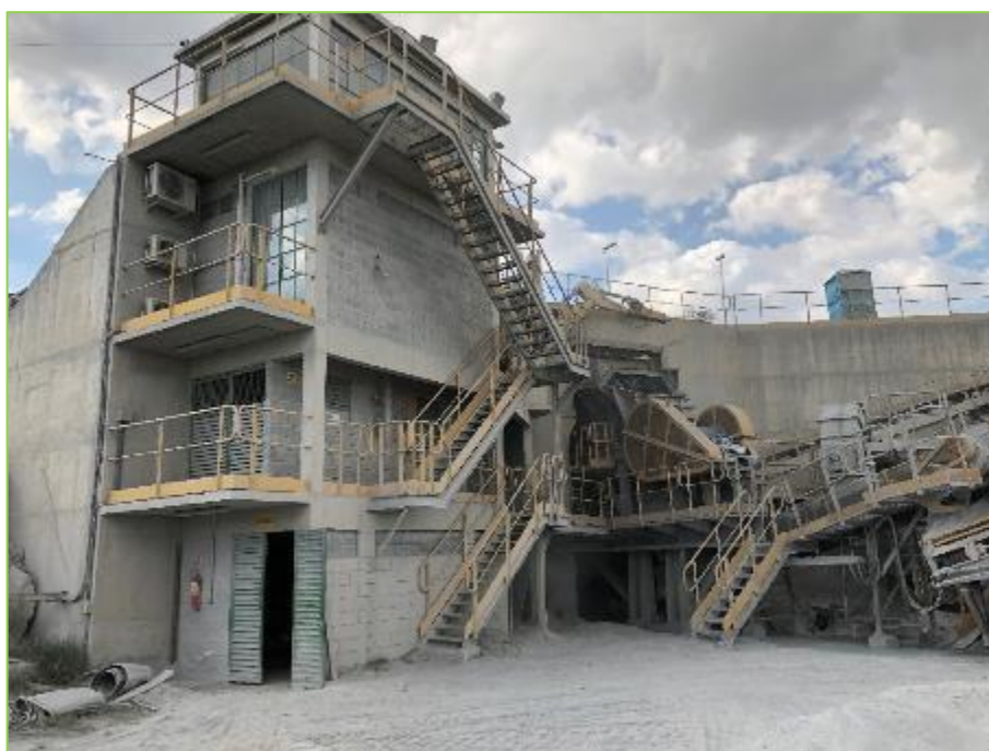
Figura 32: Alimentador Vibratório 40 x 120 (AV-40120) e Britador de Mandíbula 120 x 90 (BMI-1209).
