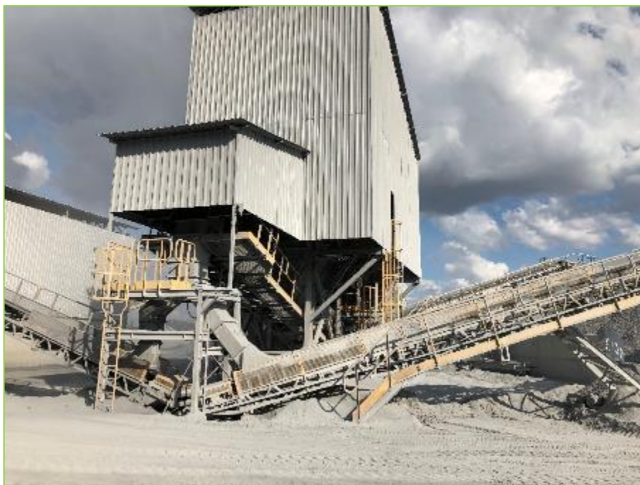
Figura 37: Transportadora de Correias TC12 saindo da Peneira Vibratória (PVI-8X20), Transportadora de Correias TC17 a esquerda e Transportadora de Correias TC16 a direita. A Transportadora de Correias TC16 possui um sistema de aspersão de água, visando evitar a propagação de poeira na formação da pilha do produto pó de calcário siderúrgico alto.
