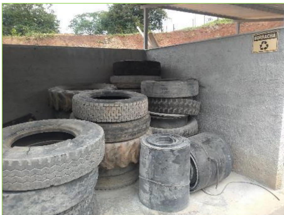
Figura 55: Exemplo da baia de depósito intermediário de resíduo industrial reciclável ou reutilizável. Baia de armazenamento temporário de borracha na área interna do depósito intermediário de resíduos sólidos.
