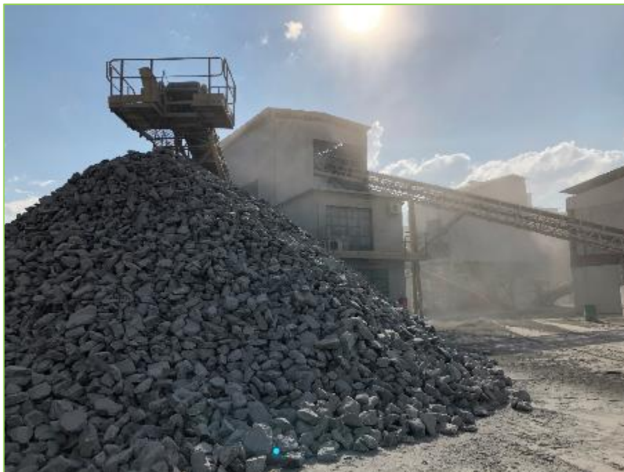
Figura 34: Transportadora de Correias TC13 a esquerda, pilha de pedra rachão e Transportadora de Correias TC07 a direita.
