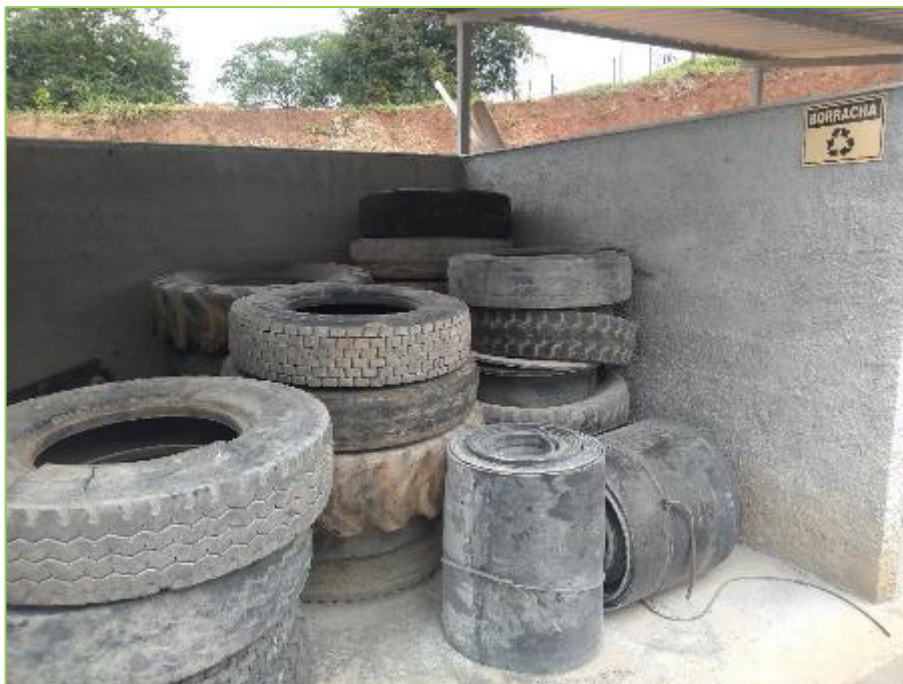
Figura 43: Exemplo da baia de depósito intermediário de resíduo industrial reciclável ou reutilizável. Baia de armazenamento temporário de borracha na área interna do depósito intermediário de resíduos sólidos.
