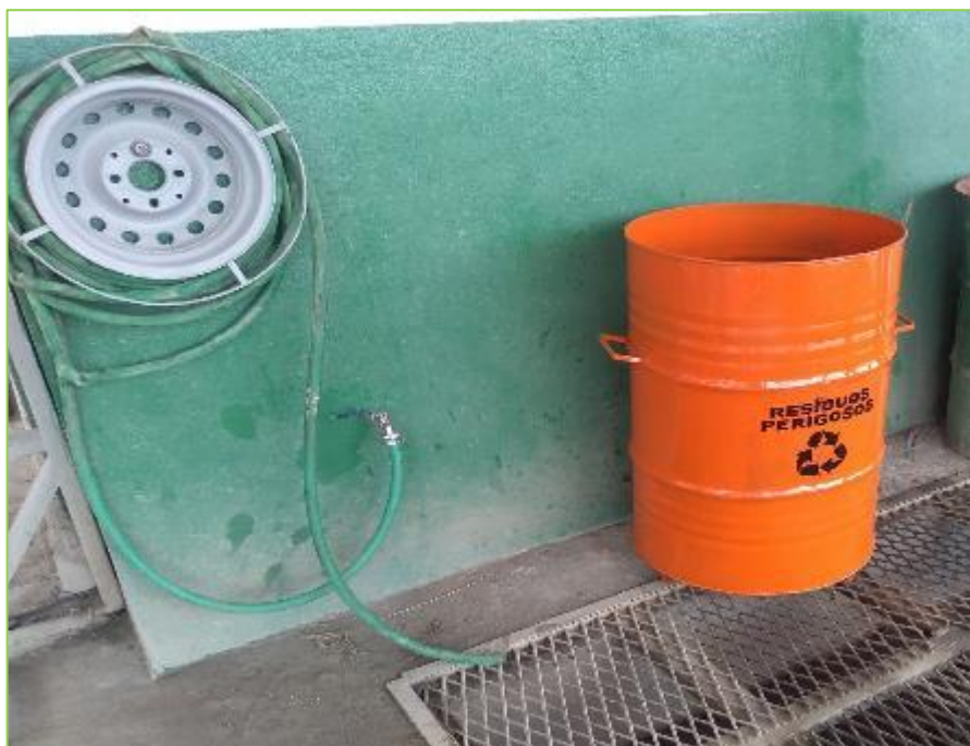
Figura 42: Tambor de armazenamento temporário de resíduos contaminados no lavador de veículos. Neste recipiente são armazenados os panos, embalagens, peças e EPI's contaminados.
