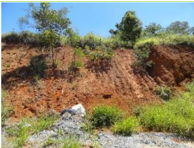
Figura 62: Cortes em estradas de serviço da Mineração Barroso, na abrangência da ADA, revelando perfil espesso e bem desenvolvido de solo do tipo Latossolo Vermelho-Amarelo.
