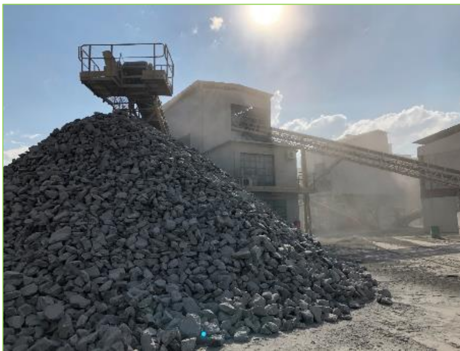
Figura 31: Pilha de pedra rachão.
