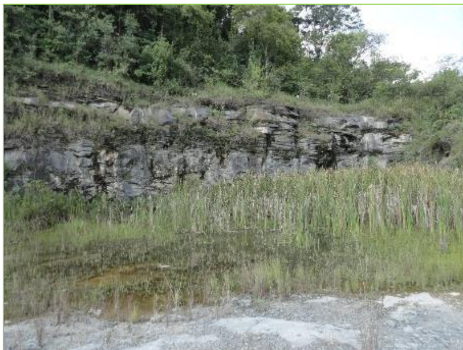
Figura 55: Afloramento de calcário em outra porção da ADA, evidenciando planos de acamamento ligeiramente inclinados e descontinuidades em razão do intemperismo a que foi exposta a rocha.
